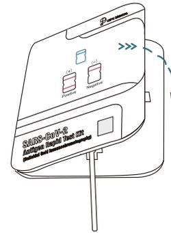
**Schritt 5:** Kleben Sie die linke und rechte Seite zusammen. Das Testergebnis wird in 15 Minuten angezeigt.
